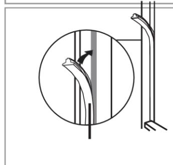
После завершения установки, если Вы удовлетворены тем, как прибор располагается в корпусе, согните и защелкните части белых накладок, помеченных буквой «S», как показано пунктирным контуром. Оставьте остальную часть разделительной крышки на месте поверх металлических пластин.
