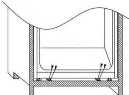
Установите уплотнитель на прибор, при необходимости отрежьте лишнюю часть. Закройте нижние части пластиковыми крышками.
