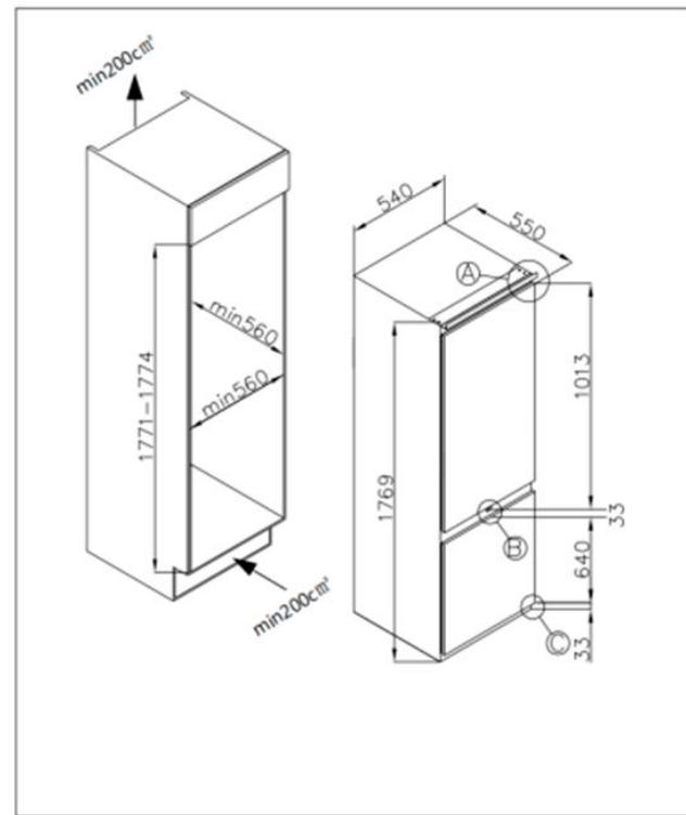
Внутри шкафа должен быть предусмотрен воздухозаборник, обеспечивающий поступление воздуха. В этом примере показано вентиляционное отверстие в цоколе под прибором. Тонкую часть цоколя можно снять, чтобы впустить воздух (рекомендуемый размер 600 мм x 10 мм).
