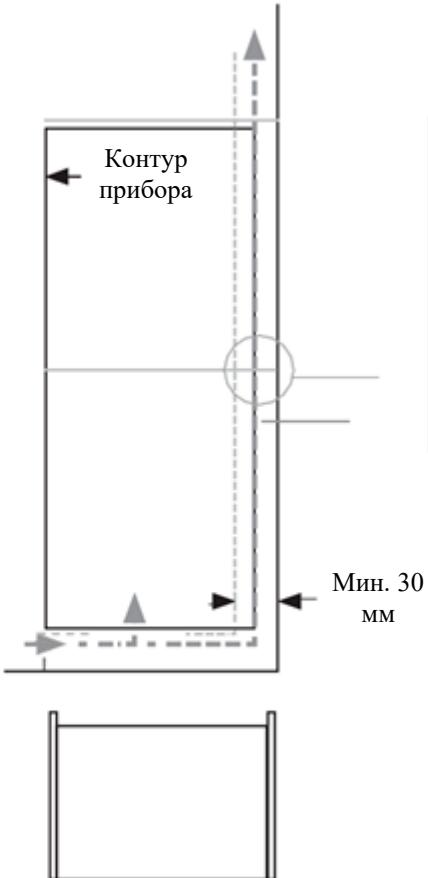
Верхняя часть шкафа должна иметь свободный выход воздуха в помещение. Рекомендуемый размер вентиляционного отверстия: 500 x 35 мм. Если мебель не пропускает свободный воздух в помещение, то необходимо - предусмотреть вентиляционное отверстие в цоколе или другие средства вентиляции для обеспечения естественного притока воздуха
