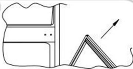
Снимите правую нижнюю петлю и левые пластиковые заглушки и установите их на противоположную сторону.
