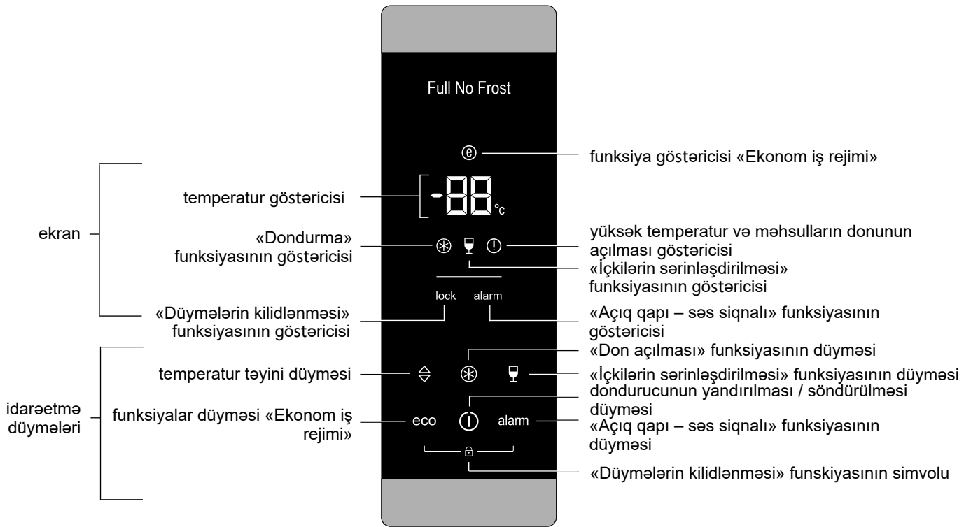
Şəkil 3 – İdarəetmə paneli
