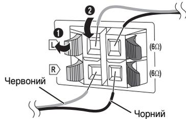
**Не допускайте випадкового контакту (замикання) або зміни полярності дротів колонки, тому що це може пошкодити колонки.**
