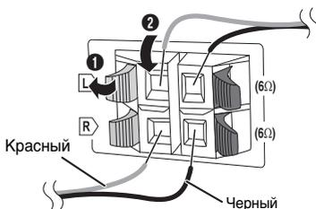
**Не допускайте перекрещивания (короткого замыкания) или неправильного соединения положительных и отрицательных проводов динамиков. Это может привести к повреждению динамиков.**
