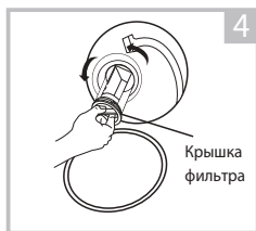
Откройте крышку фильтра, повернув против часовой стрелки
