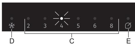
Если температура внутри прибора превышает допустимое значение, включается прерывистый звуковой сигнал и мигает индикатор (**C**) над установленной температурой.
