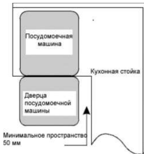
РИСУНОК 2 Минимальное пространство, необходимое для открытия двери.
