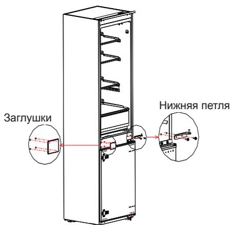
3. Снимите дверь холодильной камеры освободив её от скотча, аккуратно приподнимая и выдвигая на себя. Открутите нижнюю дверную петлю и снимите нижние заглушки с противоположной стороны двери.
