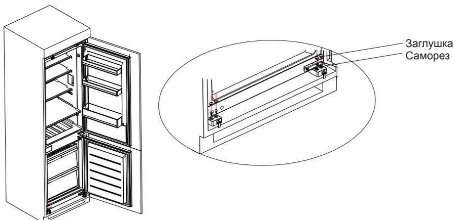
3. Прикрепите опорные ножки к шкафу при помощи саморезов. Закройте саморезы заглушками. Задвиньте нижние ограничители устранив сцепление с полкой шкафа.
