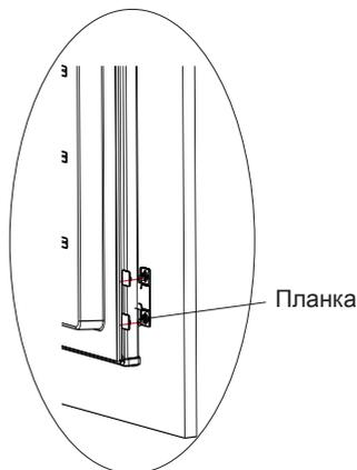
5. Откройте нижнюю дверцу установочного шкафа на максимальный угол, затем откройте дверь морозильного отделения и совместите их. Выдвиньте верхнюю и нижнюю крепежные планки наружу из-за двери морозильного отделения до упора и прикрутите их при помощи саморезов к мебельному фасаду. Затем закройте отверстия заглушками.
