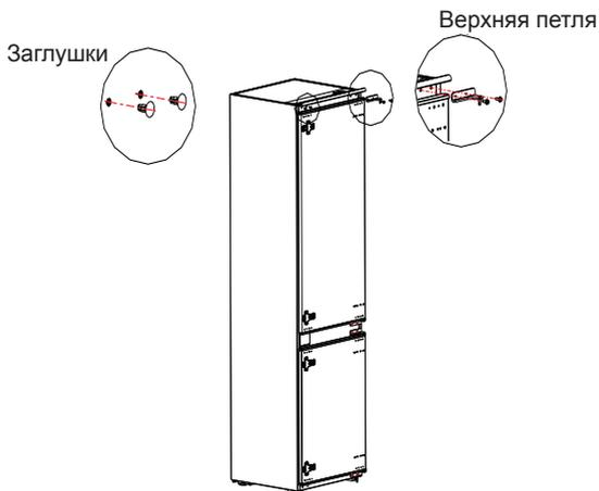
2. При помощи плоской отвертки выньте две верхние заглушки с противоположной от петли стороны двери.
