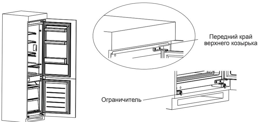
2. Вставьте холодильник в нишу не полностью. Выдвиньте до конца ограничители из опор холодильника и поверните их длинной стороной вниз, затем задвиньте холодильник в нишу так, чтобы они сцепились с передним краем нижней полки шкафа, тем самым зафиксировав глубину установки прибора. Передний край верхнего козырька должен при этом наложиться на нижний край шкафа.
