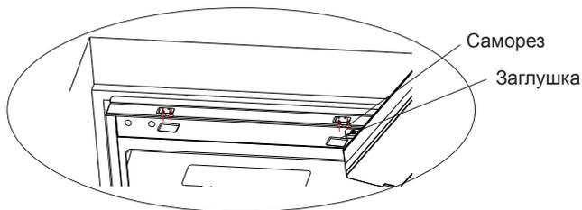
4. Прикрепите верхний козырек к шкафу при помощи саморезов, затем закройте их заглушками. Проверьте правильность закрывания верхних и нижних дверных панелей.
