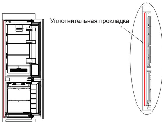
6. Установите уплотнительную прокладку в зазор между корпусом холодильника и шкафом.
