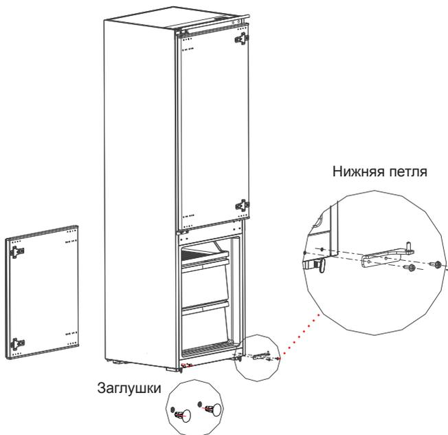
7. Демонтируйте нижнюю петлю двери и снимите две заглушки на противоположной стороне.
