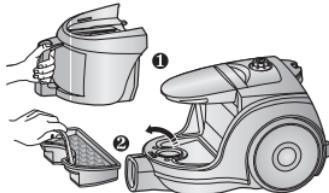
Вийміть фільтр захисту двигуна із пилососа.
