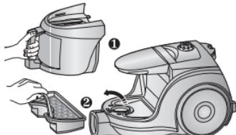
Извлеките фильтр защищающий электродвигатель из пылесоса. Вытряхните и выбейте пыль из фильтра и вставьте его обратно в пылесос.
