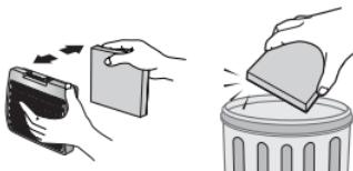
Снять и заменить засоренный выходной фильтр.
