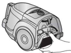
Щоб вийняти фільтр, натисніть на рамку у задній частині корпусу пилососа.
