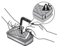
6. Помістіть зібрану касету внутрішнього фільтра у корпус пилососа.
