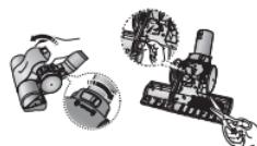
Закрыв крышку, не забудьте установить кнопку блокировки в положение LOCK (Заблокировать).
