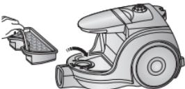
проверьте, чтобы перед помещением в пылесос фильтр был сухим. Его следует сушить в течение 12 часов.
