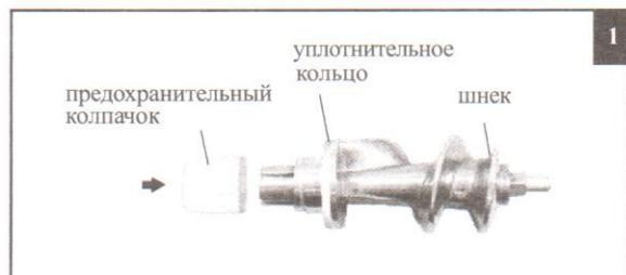
При установке уплотнительного кольца поверхность с выступом должна быть направлена в сторону предохранительного колпачка.
