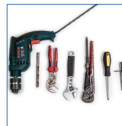
1. Для установки Вам потребуется: дрель, сверло 12 мм по металлу, разводные ключи, отвертка, торцевой трубчатый ключ на 14 мм
