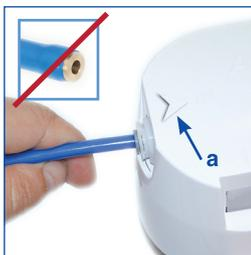
**9.** Возьмите трубку без запрессованной металлической втулки. Предварительно смочив конец трубки, вставьте до упора в фильтр, ориентируясь на стрелку (а) «вход», и закрепите стопорной клипсой
