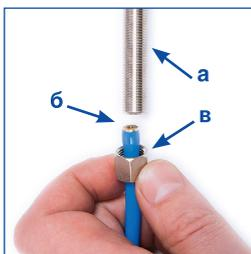
**11.** Подсоедините к крану (а) конец трубки с запрессованной латунной втулкой (б) и закрепите крепежной гайкой (в)
