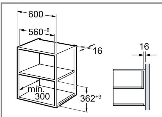
Прилад можна вбудовувати лише на тій висоті, на якій можна легко виймати з нього приладдя.
