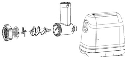
2. Вставьте шнек в камеру мясорубки длинным концом внутрь. Слегка поверните шнек, чтобы зафиксировать его в корпусе мясорубки.
