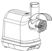
1. Одной рукой нажмите на кнопку для установки и снятия камеры мясорубки на корпусе, другой рукой возьмите камеру мясорубки и вставьте ее в отверстие для установки, повернув против часовой стрелки. Затем отпустите кнопку. Слегка покачайте камеру мясорубки, чтобы убедиться, что она надежно закреплена.
