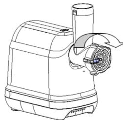
Чтобы снять камеру мясорубки, одной рукой нажмите на кнопку для установки и снятия камеры,
