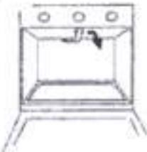
4.2 - Снимите онфорку/форсунку, открутив винт, фиксирующий форсунку, и выньте все комплектующие, повернув держатель форсунки вниз.
