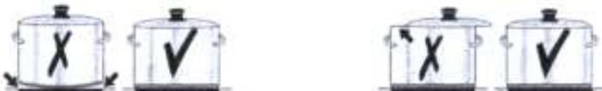
Не используйте емкости с диаметром дна меньше диаметра конфорки.
