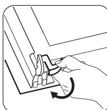
**5** Вивільніть систему блокування для того, щоб витягнути внутрішню скляну панель.
