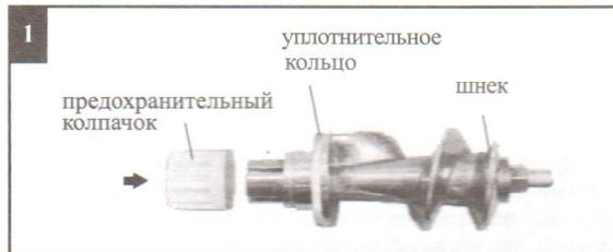
При установке уплотнительного кольца поверхность с выступом должна быть направлена в сторону предохранительного колпачка.
